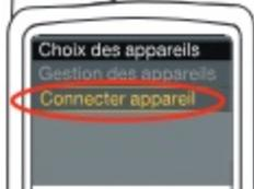
7. Utilisez la flèche de défilement vers le bas pour faire défiler l'écran jusqu'à **Fonctions**. Appuyez sur la touche **Sélectionner** . Dans le menu Fonctions, utilisez la flèche de défilement vers le bas pour faire défiler l'écran jusqu'à **Choix des appareils**. Appuyez sur la touche Sélectionner.
