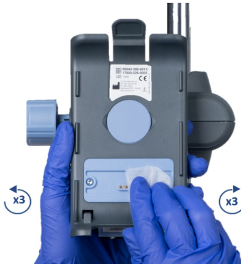
Figure 11.1. Nettoyage des connecteurs électriques
