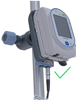
Figure 2.18. Recharge de la batterie du Sapphire Connect par le biais d'un mini-support
