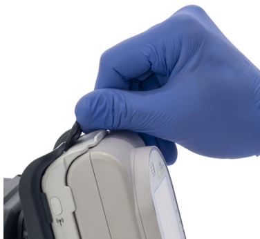
Figure 2.23. Déconnexion du mini-support
